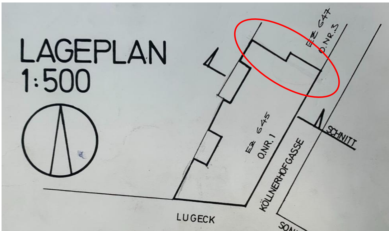
Lageplan Köllnerhofgasse 1; EZ 645 vom Jänner 1982 (Feststellungsbescheid vom 28.05.1982) – die Grundstücksgrenze ist falsch eingezeichnet (Bauakt Köllnerhofgasse 1)
