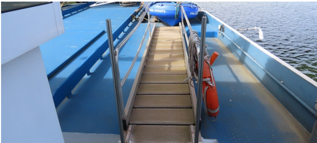
Abbildung 5 Treppe mit variablen Stufen und Geländer
