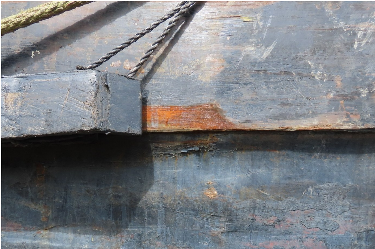
Abbildung 91 Frische Schleifspuren an der Bergplatte der Stb.-seite
