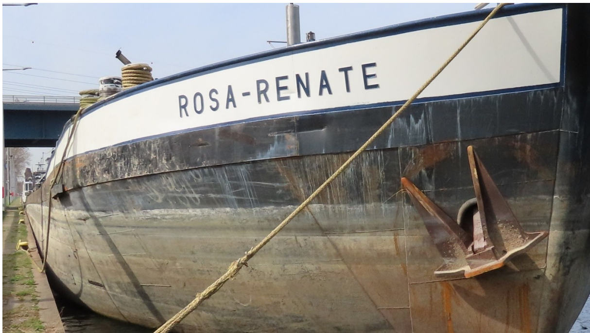
Abbildung 90 Deformationen in der Bergplatte am stb.-seitigen Vorschiff
