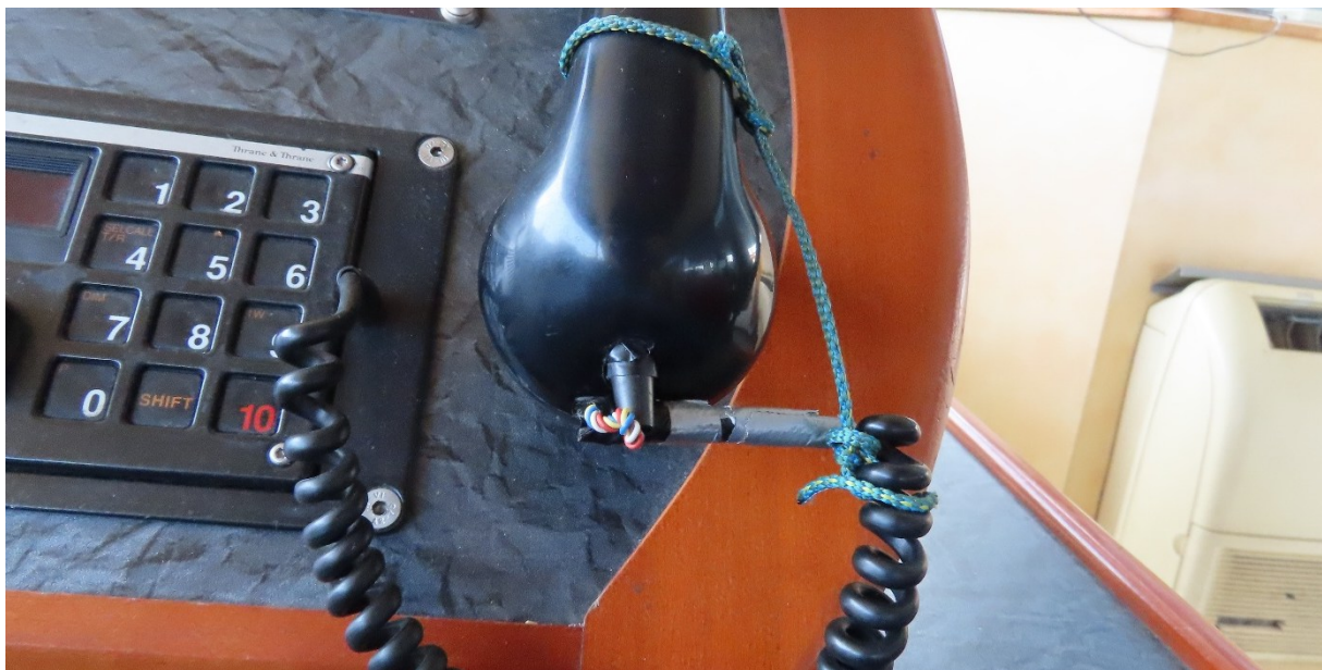
Abbildung 20 abgerissenes Kabel am stb.-seitigen Funkhörer
