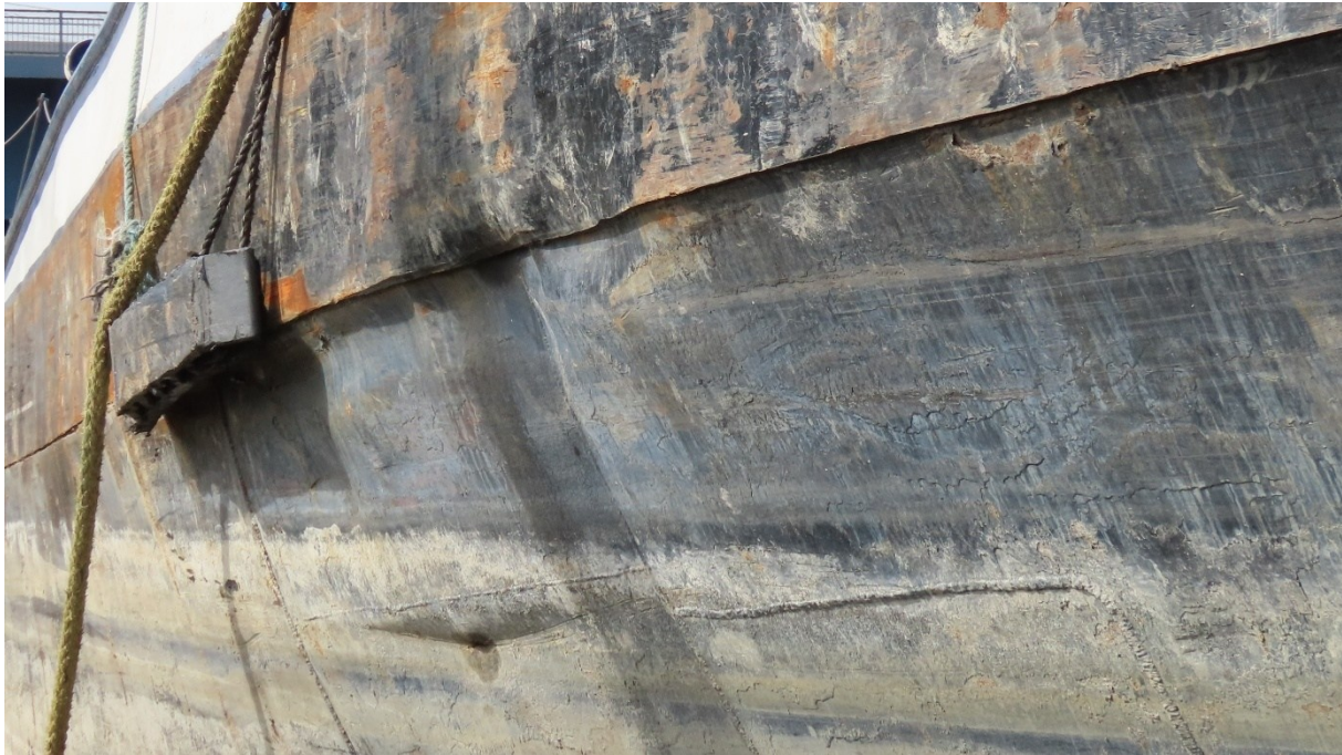
Abbildung 89 Starke Deformationen am Vorschiff auf der Stb.-seite
