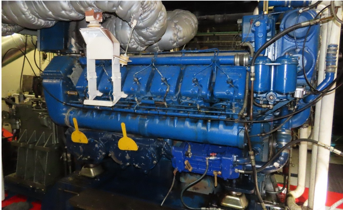
Abbildung 22 Hauptmaschine Deutz Typ: TBD 604 BV 12
