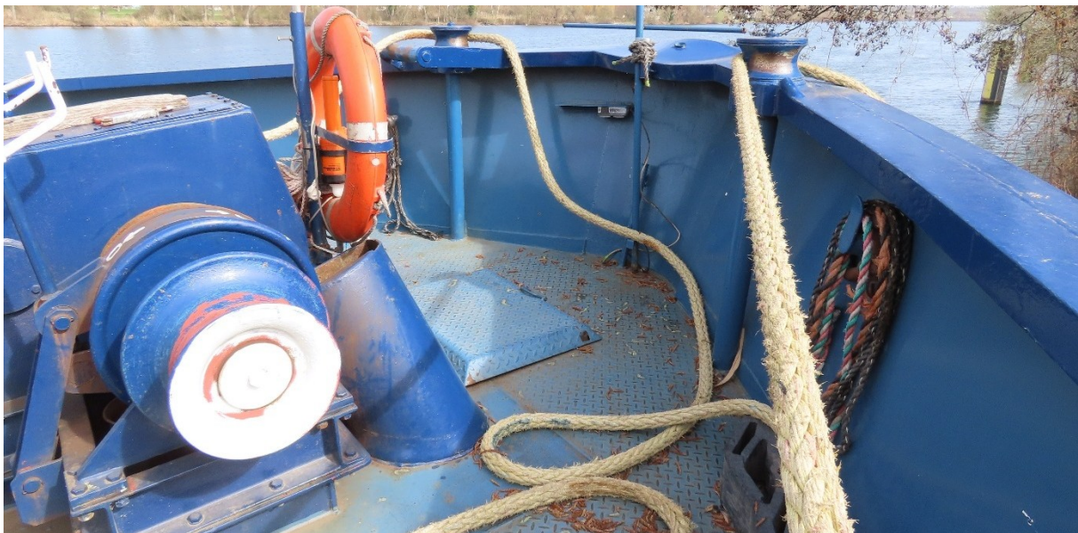
Abbildung 53 Zustand Konservierung Verschanzung und Vorschiff
