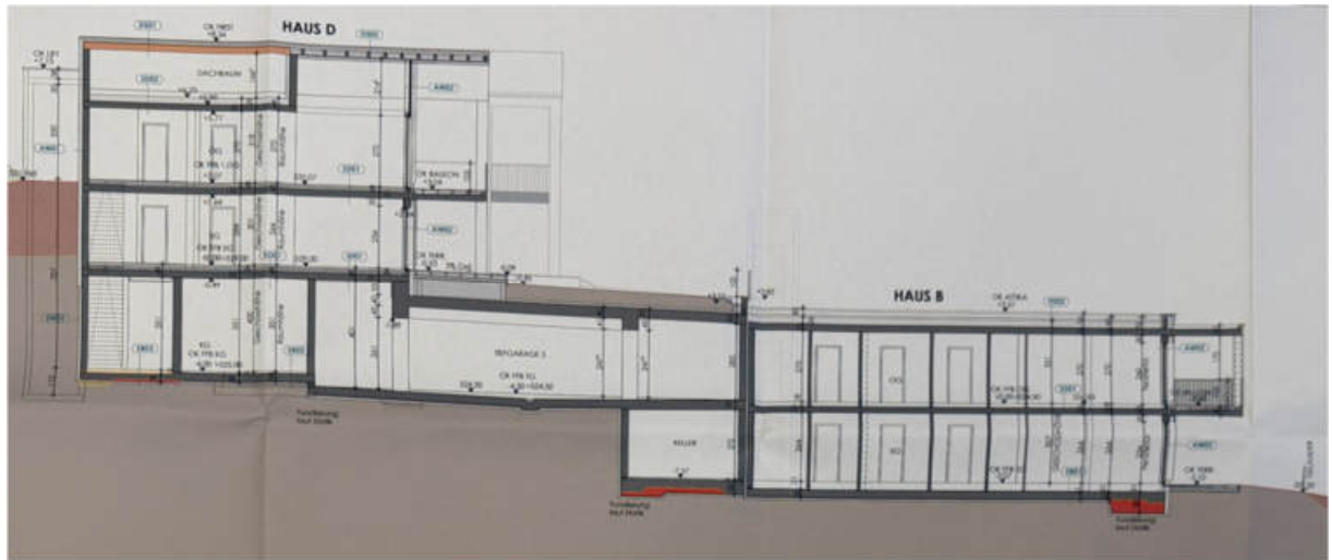
Abb. 27: Haus B und D – Schnitt (Tiefgarage 3)
