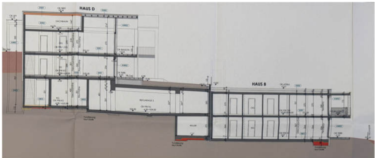
Abb. 27: Haus B und D – Schnitt (Tiefgarage 3)
