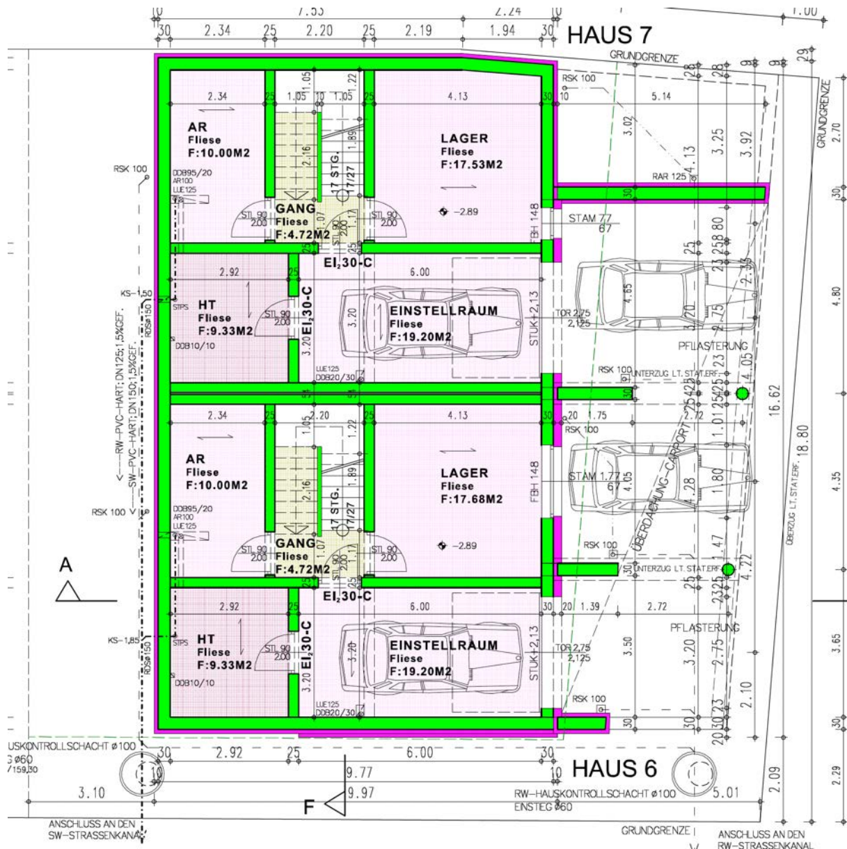
Abbildung 58 Einreichplan – Keller Haus 6+7 / Quelle: auftraggebende Partei
